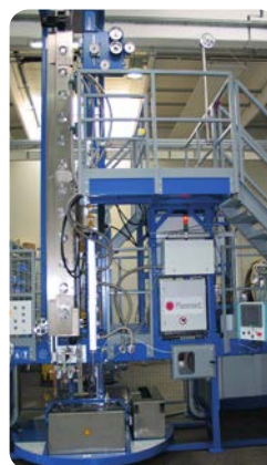
PlasmaPREPLATE verticale: ricottura e preparazione della superficie prima della placcatura per annagamento a caldo
