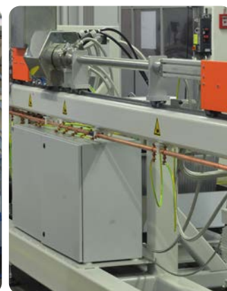
PlasmaPREPLATE verticale: ricottura e preparazione della superficie prima della placcatura per annagamento a caldo
