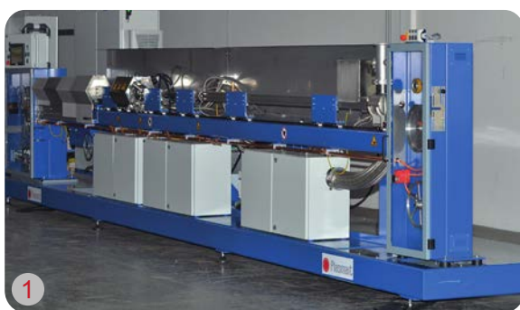
1 PlasmaANNEALER, impegno su cavi, fili, corde fino a 5mm 2 in acciaio inossidabile
