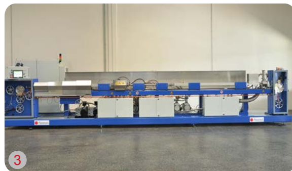
2 PlasmaANNEALER, impegno su fili di diametro da 0.5 a 5mm in acciaio inox e leghe di nickel
